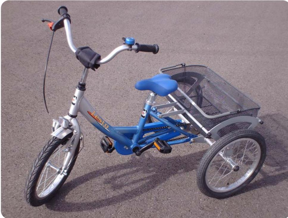
⇒ Fabriqué sur la base d'un vélo, les modèles << LESTO >> sont dotés d'un essieu arrière large. La grande stabilité ainsi obtenue assure la confiance des utilisateurs et la bonne prise en main du tricycle.
