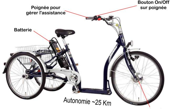
Moteur dans le moyeu de la roue avant
